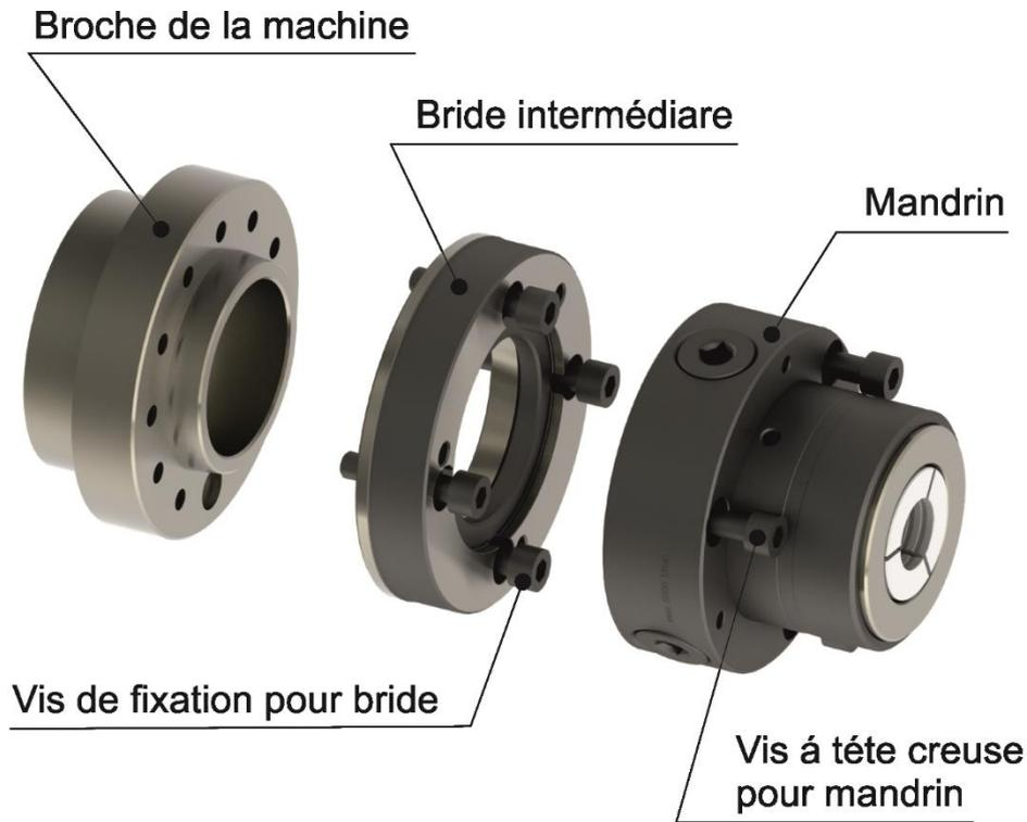
Nettoyer la broche de la machine et la bride intermédiaire (faux plateau). Dégraisser les filets de serrage dans la bride.
