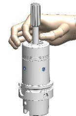
Bild 3 – Werkzeug einstecken und Spannmutter von Hand spannen
