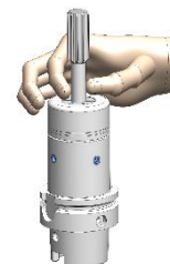
Image 3 – Insérer l'outil et visser l'écrou à la main
