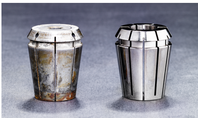
Due pinze portautensili dopo rispettivamente 4 mesi di impiego: a sinistra senza, a destra con rivestimento FAHRION|Protect
