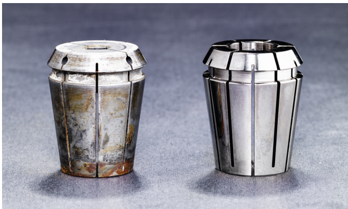
Deux pinces de serrage après 4 mois d'utilisation respectivement: A gauche sans revêtement – à droite avec FAHRION|Protect
