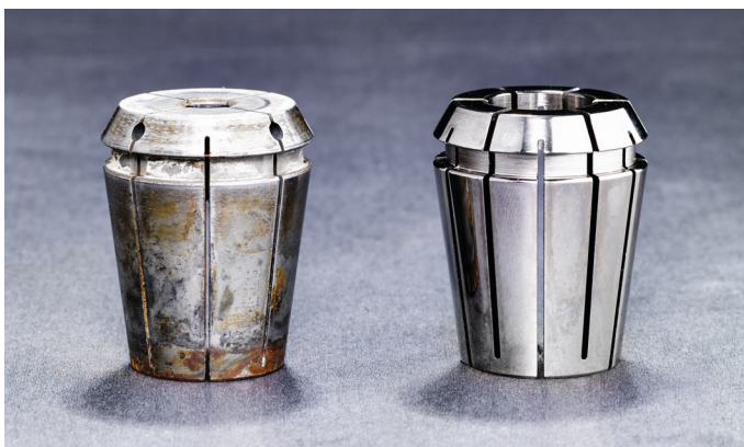
Zwei Spannzangen nach jeweils 4 Monaten Einsatz: Links ohne Beschichtung – rechts mit FAHRION|Protect
