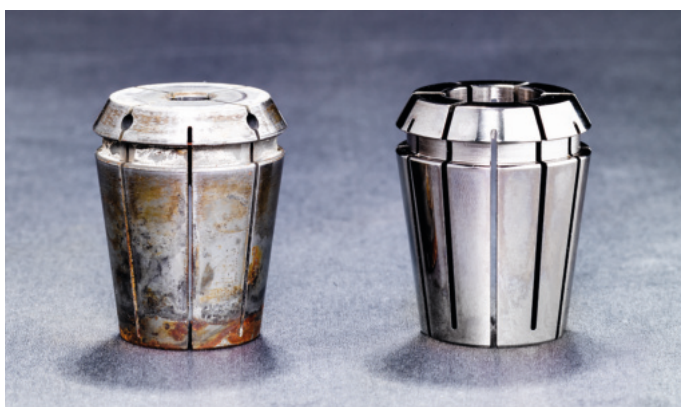
Due pinze di serraggio dopo rispettivamente 4 mesi di impiego: a sinistra senza, a destra con rivestimento FAHRION|Protect
