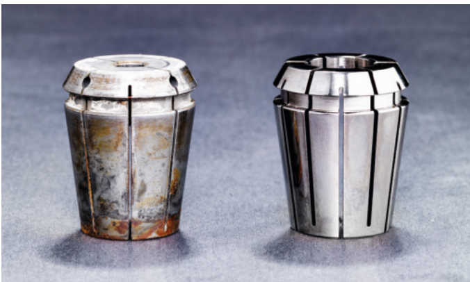
兩支彈簧筒夾均經過 4 個月的使用: 左側沒有保護膜, 右側披覆 FAHRION|Protect 保護膜
